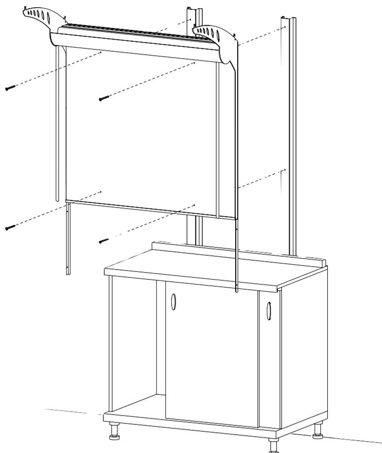
**Montare lo schienale in melaminico sui montanti con viti 3,9x25, posizionandolo con il profilo lamiera zincata posteriore e collegare quindi l'impianto elettrico.**
