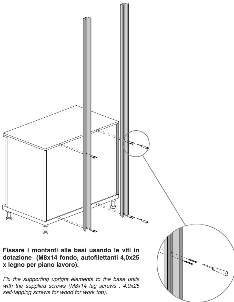
**Fissare i montanti alle basi usando le viti in dotazione (M8x14 fondo, autofilettanti 4,0x25 x legno per piano lavoro).**
