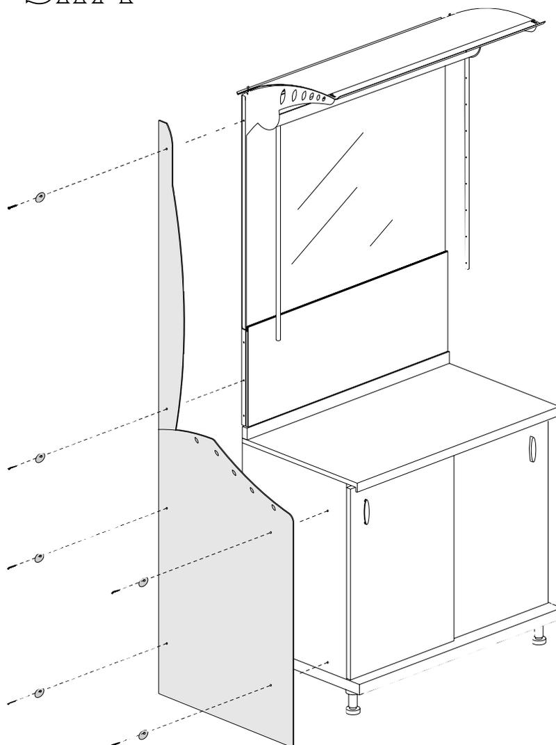
**Montare le fiancate per le basi e alzate con viti autofilettanti e gli appositi ovuli in zama.**
