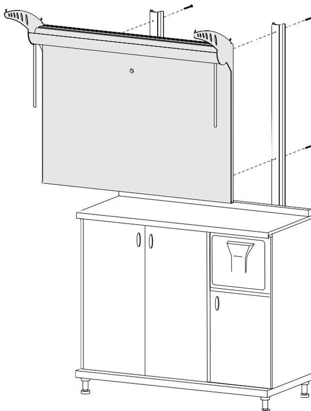
**Montare lo schienale in acciaio inox AISI 304 sui montanti con viti 3,5x16, posizionandolo con il profilo lamiera zincata posteriore e collegare quindi l'impianto elettrico.**
