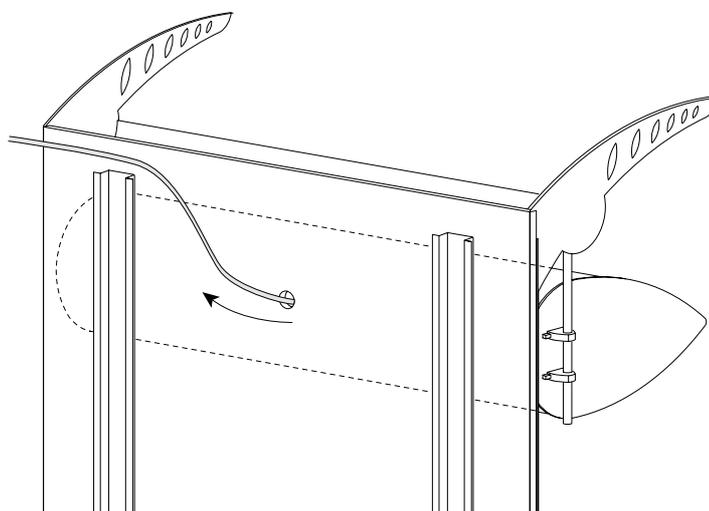
**Far passare il cavo di alimentazione nell'apposito foro nello schienale e collegarlo all'alimentazione passando da sopra. Collegare anche l'alimentazione del plafone.**
