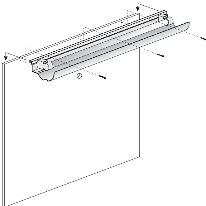
**Premontare sugli schienali in acciaio inox AISI 304 la plafoniera completo di impianto e schermo con viti autofilettanti 3,5x16.**
