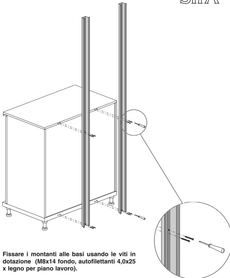
**Fissare i montanti alle basi usando le viti in dotazione (M8x14 fondo, autofilettanti 4,0x25 x legno per piano lavoro).**
