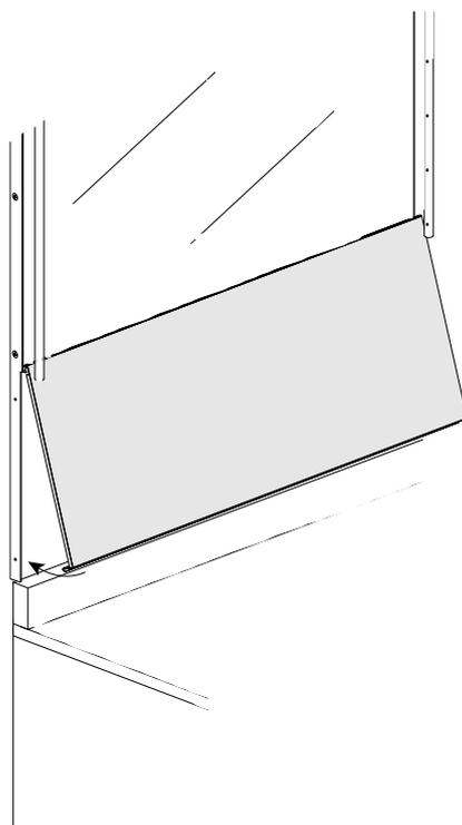
**Montare l'alzatina inox scatolata agganciandola in alto sul profilo inferiore reggimensola e sotto tra l'alzatina del top inox e i montanti.**
